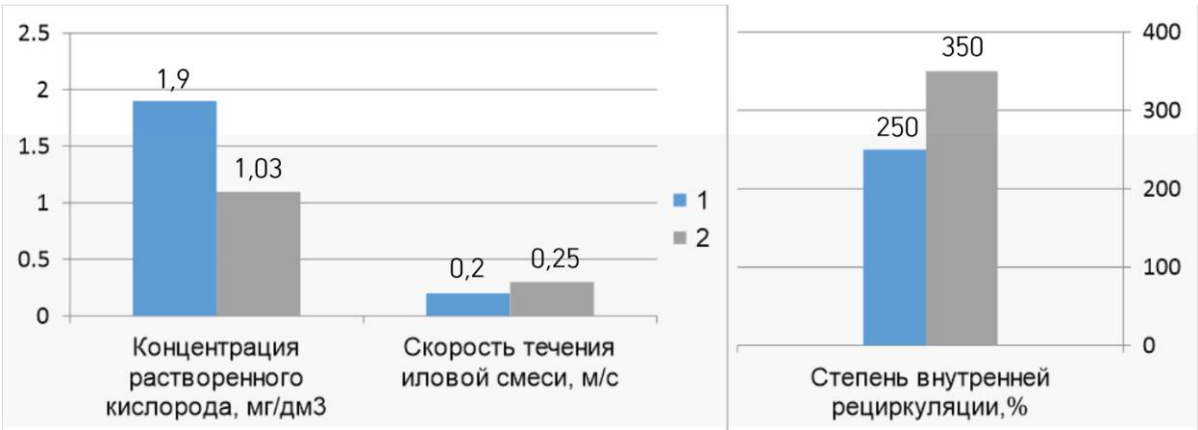
Рисунок 2. Зависимость скорости течения и степени внутренней рециркуляции иловой смеси от кислородных условий в окислительном канале
