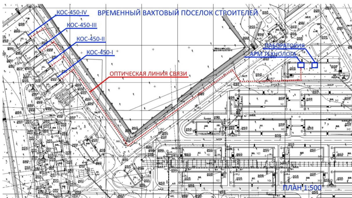
Рисунок 1. Схема вахтового поселка строителей с объектами системы канализации и инфраструктуры
