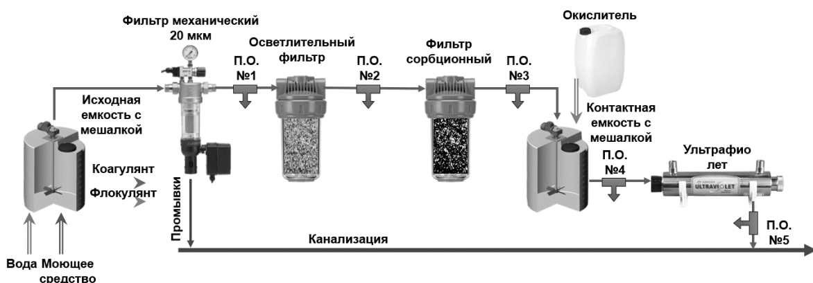
Рисунок. Технологическая схема лабораторной установки для очистки «серых» вод
