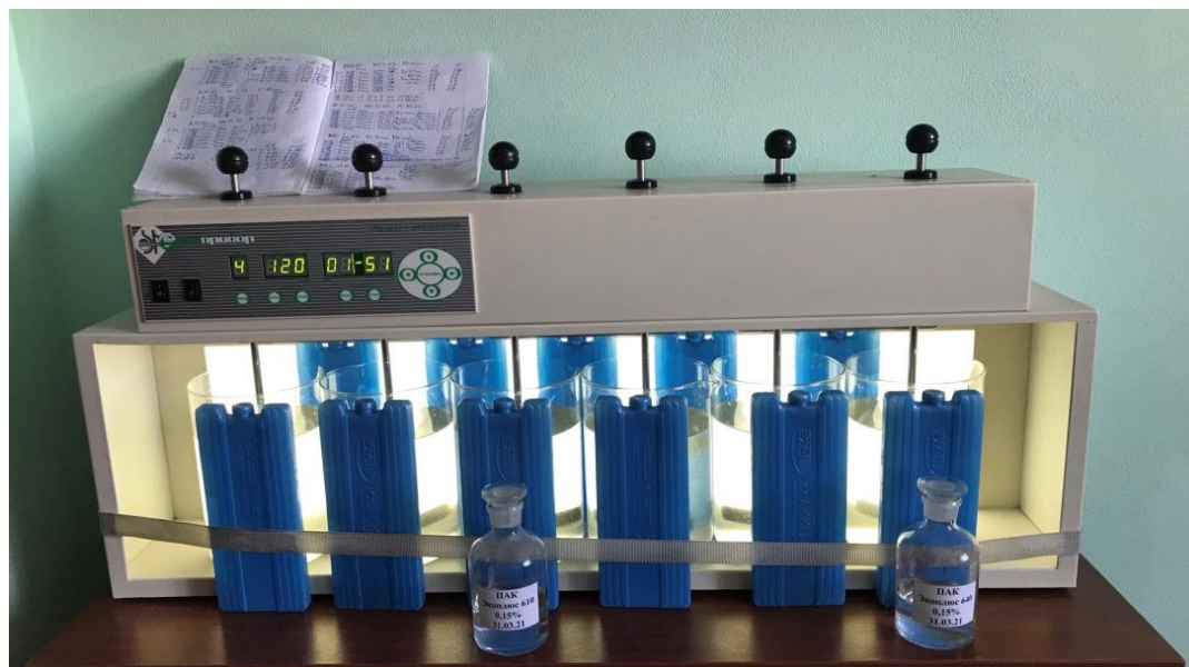
Рисунок 2. Общий вид флокулятора при проведении пробной коагуляции в зимний период (с аккумуляторами холода для поддержания низкой температуры воды)
