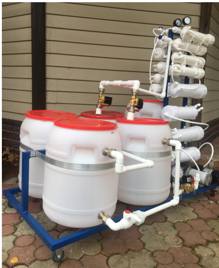
Рисунок 4. Внешний вид опытно-промышленной пилотной установки обратного осмоса производительностью 150 л/ч с блоком радикального сокращения расхода концентрата
