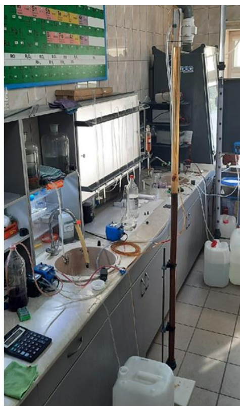
Рисунок 2. Экспериментальное моделирование второй ступени фильтрования на лабораторной колонке:
